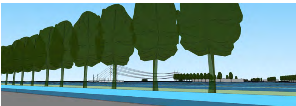
Fig. 3.2.4f: Inpassing door het aanbrengen van een boombeplanting langs een weg/recreatieve route op enige afstand van de installatie.
